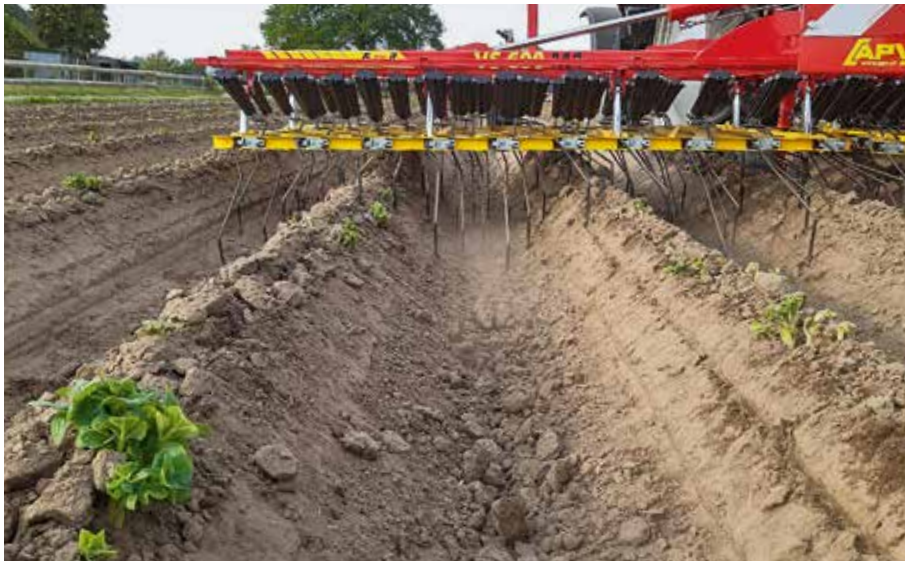
Beim Einsatz in Dammkulturen ist die flexible Zinkenaufhängung im Vorteil.
