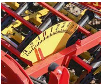
Eine gut sichtbare Skala zeigt die Einstellung der Zinkenvorspannung an.
