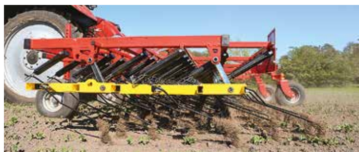
In einer Hülse sind die Federn geschützt und über dem Zinkenstragrahmen untergebracht – das verhindert das Einklemmen von Blättern und beugt Pflanzenschäden vor.
