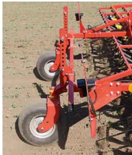
Die gelenkten Tasträder hinten (Option) sind zu empfehlen, um im Langloch fahren zu können.
