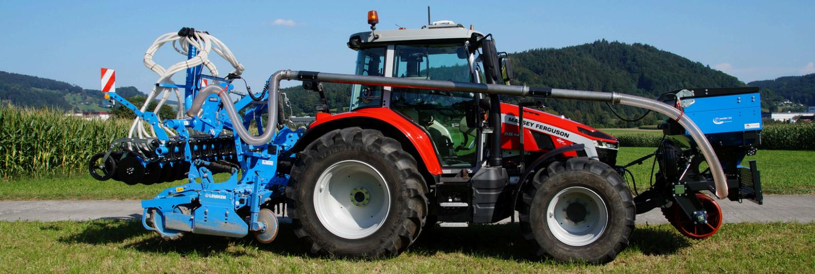
Die über den Oberlenker zurückbauende Form unserer Tanks ermöglicht geringen Überhang nach vorne und maximales Volumen bei geringer Bauhöhe. Der FT 650 und FT 1000 können durch einen passenden Aufsatz für mehr Volumen erweitert werden.
